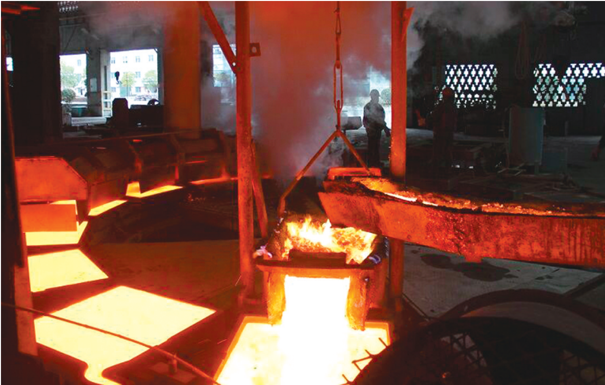
2月10日,张家港铜业公司精炼车间正在进行阳极板浇铸作业。春节期间,这个公司广大员工主动放弃回乡与家人团聚的机会,始终坚守在生产岗位上,确保了电解系统满负荷生产。2月4日至10日,共生产电解铜6000吨,平均日产857吨,A级铜率99.15%,均创历史同期最好水平。
