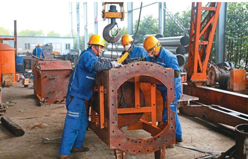
铜冠矿建公司机修分公司职工新年里正在维修中心回转抓岩机。这个分公司依靠自身技术力量积极开展矿建设备维修,较好地满足了铜冠矿建公司生产需要。
