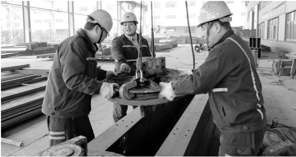
为盘活设备资产,新年伊始,铜冠建机械修造分公司启动返库闲置设备的修理工作。该分公司针对各车间制定设备修理激励考核政策,在确保日常加工制作生产任务的基础上,合理调剂和优化维修人员,做到分工不分家、设备修理不断档。目前,该分公司正在积极组织开展液压伞钻、悬吊大桶、灰桶和天轮的修理工作。图为员工正在修理提升机天轮。
