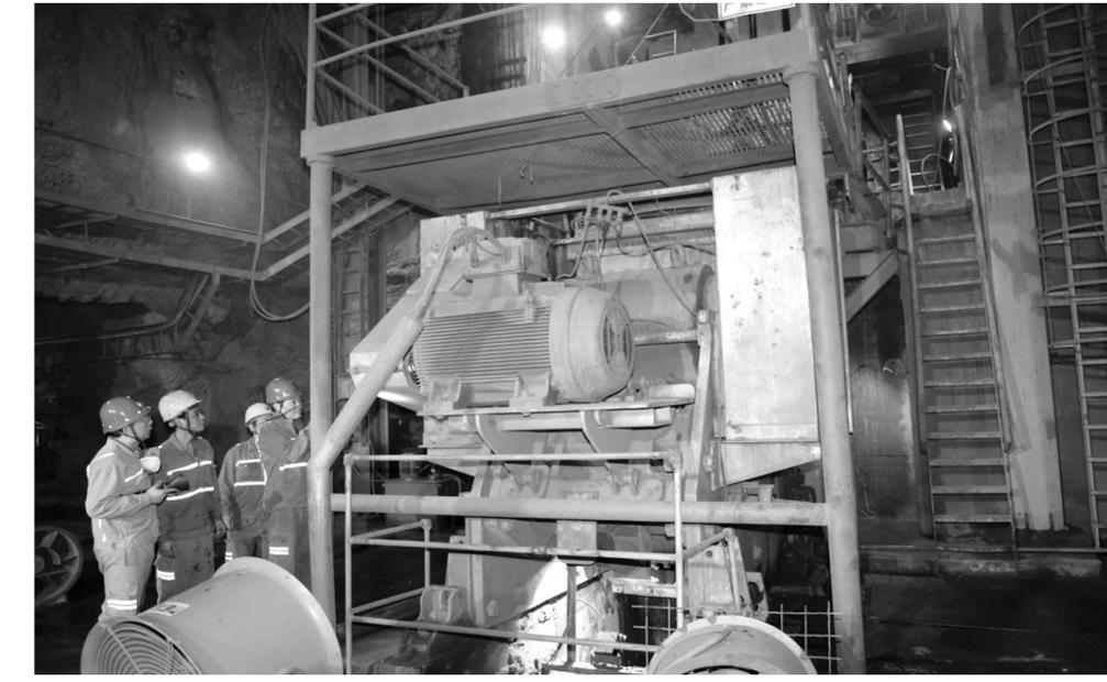
冬瓜山铜矿续建工程历经8年建设,目前全面通过安全设施竣工验收,成功投入生产。该工程在国内首次攻克了千米井下1460米长胶带运输系统等技术难题,并创下国内有色金属矿山第三口深井的纪录,产量达到7000吨/天,确保了冬瓜山产能稳定。图为这个矿一线职工正在维护冬瓜山铜矿床续建工程井下负1023米中段破碎机。
