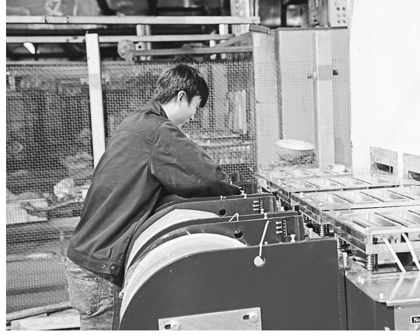
铜冠电工公司员工日前正在漆包机改造中作业。该公司继去年将漆包线分厂闲置的漆包机成功改造成两台铝线漆包机后,新的一年将加快闲置的漆包机改造进度,进一步扩大铝线生产,努力使闲置设备得以有效利用。 王红平 华伟 摄
