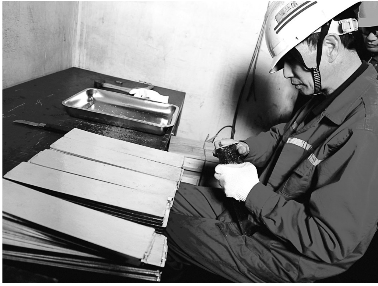
金隆铜业公司职工正在对刚浇铸出的黄金产品外表进行打磨修正。该公司坚持质量至上理念,对产品质量精益求精,稀贵金属产品从原料进厂的首道工序开始就实行全过程质量监控,杜绝不合格产品出现,黄金、白银产品远销国际市场,受到客户欢迎与好评。 章庆摄
