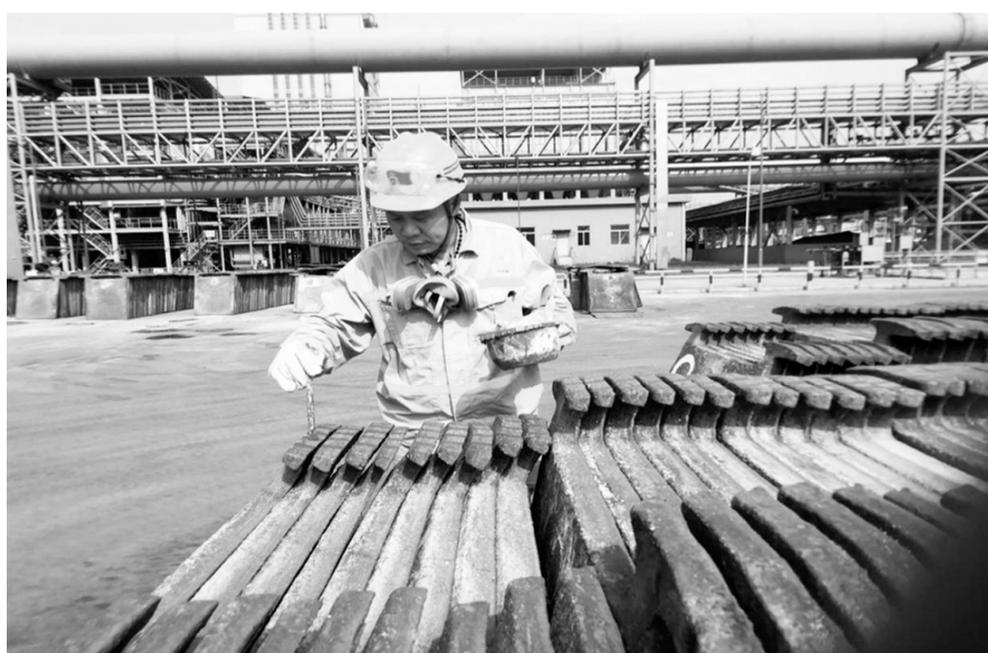
金冠铜业分公司奥炉精炼车间牢固树立产品意识,规范岗位操作,及时跟踪阳极板质量,对阳极板进行抽检称重,保障阳极板单重达标。同时,加强班组自检,标注记号,便于准确、快速找出存在问题并制定解决方案,全面提升产品质量。图为操作人员对阳极板进行自检、标注。 汤虎 摄
