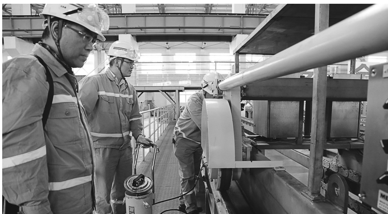
金冠铜业分公司奥炉厂职工正在为链用阴极剥片机组加润滑油。奥炉厂为加强对电解车间试车期间的设备磨合,针对链用阴极剥片机组特点,积极做好保全维护工作,及时定期为剥片机组增添润滑油,保障了剥片机组稳定运行。
