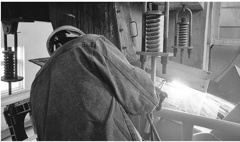
日前,铜冠(庐江)矿业公司对选矿车间5号皮带振动给料机进行技改,将其出口替换为插板式阀门,变振动手下料为自流式给矿,在节约电能的同时保障了生产稳定。
