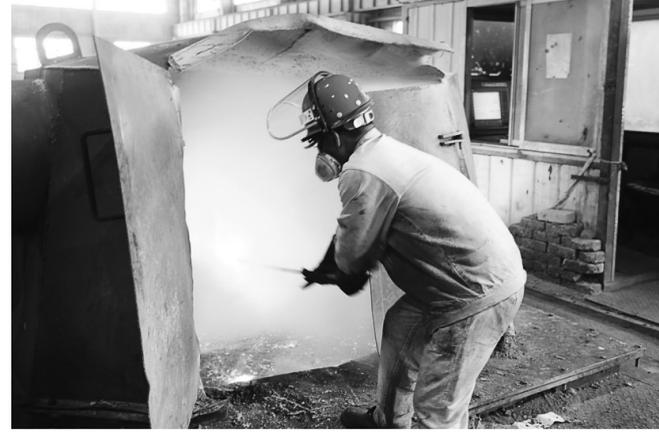
铜冠黄铜公司职工日前正在炉前作业。铜冠黄铜公司今年积极依靠自身技术力量对熔铸系统无芯炉、保温炉等进行了大修和技改,使得熔铸生产成功实现提速,铸造速度由每小时3.5吨提升到5吨,大幅提高了铸锭供给能力。
