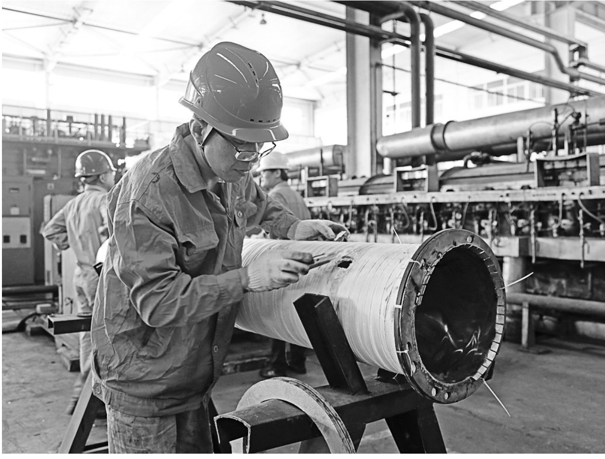
铜冠黄铜公司职工正在更换感应炉内胆配件。铜冠黄铜公司为解决长期以来生产与维修的矛盾,充分调动生产操作人员参与维修的积极性,缓解公司维修力量不足的问题,将公司维修人员划入车间管理,提高了解决突发故障的及时性。
