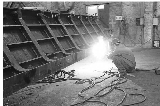
铜冠机械公司矿冶分厂职工日前正在制作烟道。铜冠机械公司矿冶分厂制作的这个烟道是奥炉技改工程上的奥炉过渡烟道,烟道从7月开始制作。分厂抽调精干力量投入制作,保证了加工进度,目前制作基本完工。王红平 廖肇迪 摄
