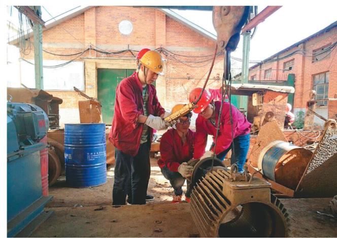
10月16日,天马山矿业公司员工正在对电机进行修理维护。这个公司加大修旧利废力度,提高设备的使用率,从细小处挖潜增效,降低生产成本。
