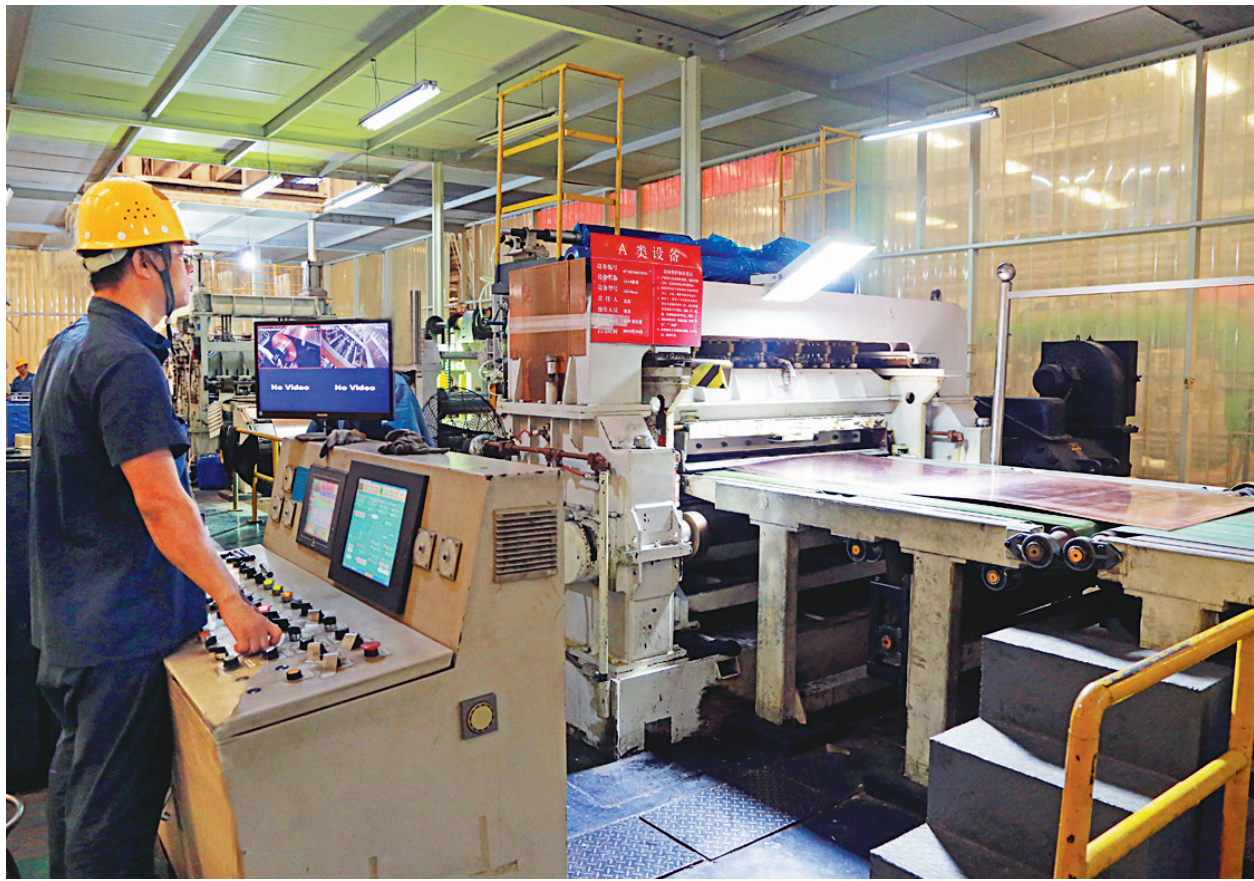
金威铜业公司板带分厂职工日前正在进行带板材剪切作业。金威铜业公司板带分厂1250横剪机组是该公司惟一生产带板材的剪切生产线。该机组生产的带板材因板型好,性能优良,目前已成为国内高铁铜母排所采购铜板的主要供货资源。
