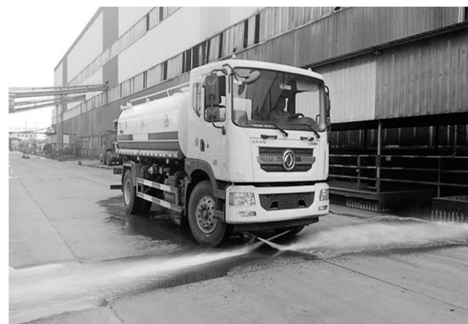
冬瓜山铜矿精矿车间由于运输精砂过程中洒落严重,道路经常是晴天一落灰,雨天一脚泥。近日,该矿为该车间购置了一辆洒水车定时对路面进行喷洒除尘(如图),有效控制了粉尘污染,减少了金属流失。
