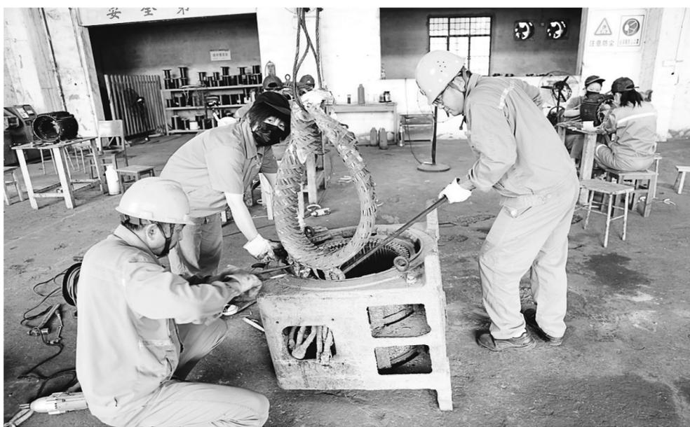
四季度将至,安庆铜矿掀起了大干热潮。为了确保安全生产,该矿强化对设备的维护和保养,保证做到安全、可靠和高效率。图为该矿机修厂正在对选矿电机进行抢修和维护。
