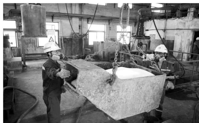
金隆铜业公司冶炼二车间职工正在往精炼渣磨料浸出釜中运送添加剂。该车间精准控制各项物料添加,通过最优技术工艺去除精炼炉渣中价值不高的复杂金属,强化金、银、铈等稀贵金属的归集,为企业增加经济效益。
