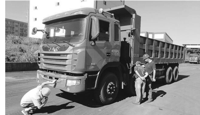
为强化外协运输车辆的安全管理,铜冠物流公司冬瓜山车队组织了专门安全检查小组到各运输点对外协运输车辆进行制动、转向、传动、灯光等系统检查,以确保运输车辆运行可靠。图为该车队专门安全检查小组正在对外协车辆进行检查。
