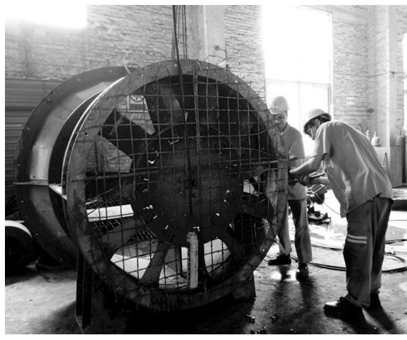
今年以来,冬瓜山铜矿动力车间始终咬定降本增效目标不放松。1至7月份,该车间修复200千瓦变频器1台、2×11千瓦对旋式风机1台、11至18.5千瓦风扇5台,以及锚杆锚机等设备零部件,节约材料费用10万余元,有效降低了生产成本。图为该车间职工对近期从井下回收来的废旧局扇进行修复再利用。陶信宁 摄
