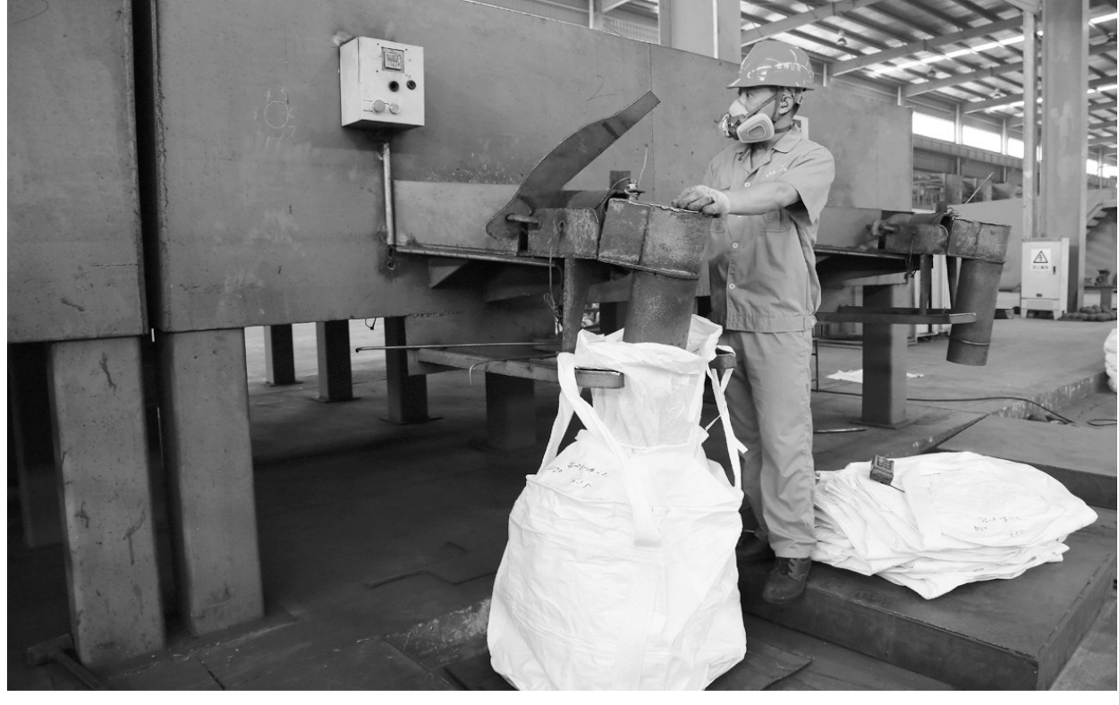
铜冠投资金矿耐磨材料公司职工日前正在进行球磨机装袋打包。铜冠投资金矿耐磨材料公司针对过去球磨机装袋费时费力且不安全的情况,积极开展技术攻关,成功制作了球磨机自动装袋设备,做到了自动装球并准确计数,大大提高了装袋速度,降低了工人作业强度。 王红平 施家龙 摄
