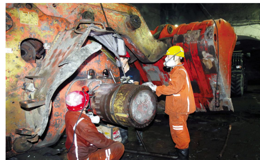
冬瓜山铜矿针对矿山进口大型无轨设备备件维修维护费用高、成本大、供货不及时等情况,坚持自主维修,每年可为矿山节约费用数百万元。图为维修班员工正在对电动铲运机前桥进行更换。 方咸达 汤 菁 摄
