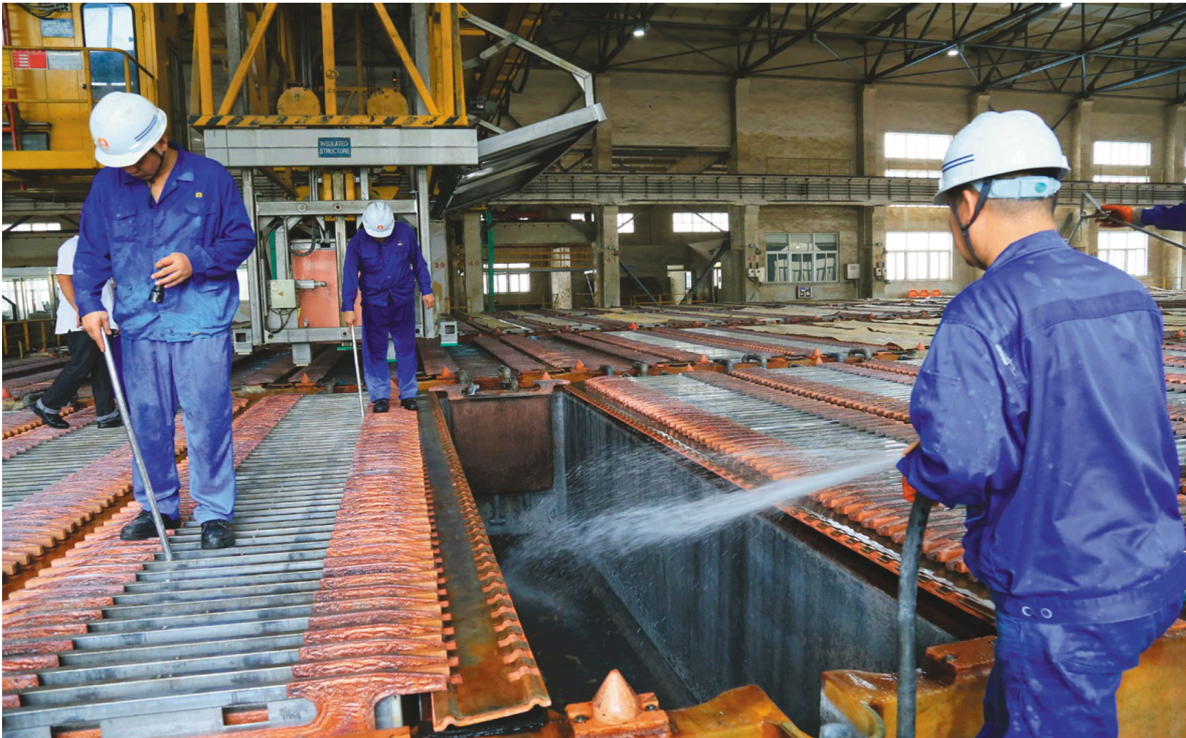
高温期间,金隆铜业公司职工正在闷热的车间里进行整缸和清洗电解槽工作。
