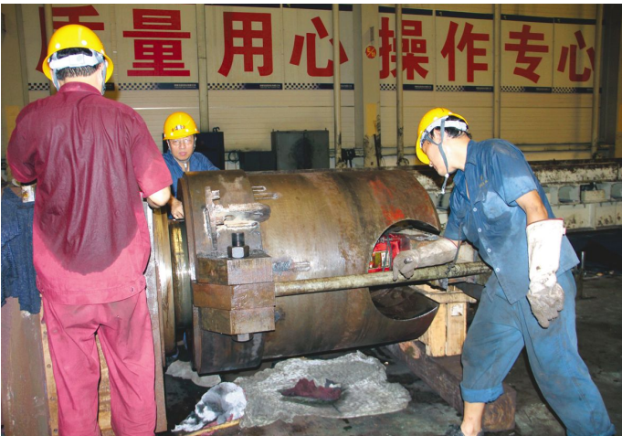
金威铜业职工更换热轧辊轴承。 黄军平 摄
