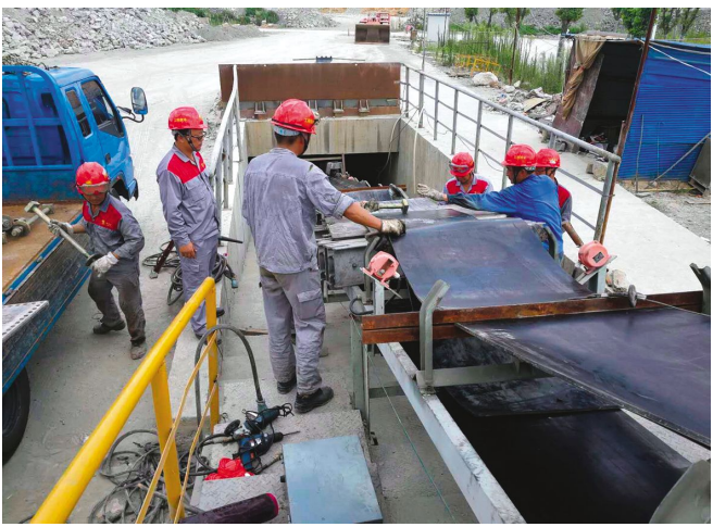
工程技术分公司职工在室外温度突破50摄氏度高温下对矿石输送机皮带进行检查,更换皮带。 吴义龙 摄
