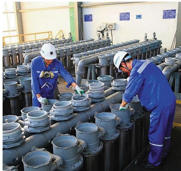
金隆业公司金属回收车间职工正在进行旋流电积槽槽面作业。旋流电积工艺是从铜阳极泥浸出铜溶液中提取标准阴极铜,电积残渣再进入铜阳极泥浸出工序中循环使用,实现铜的全部综合利用,充分体现循环经济理念。章庆 蔡志刚 摄
