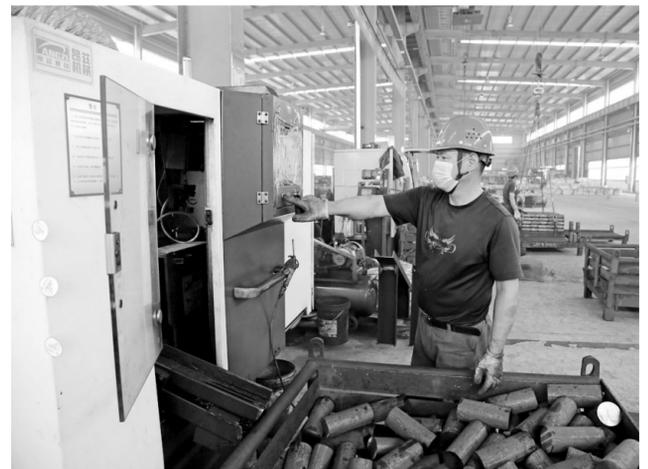
铜冠投资金神耐磨材料公司职工日前正在钢坯切切作业。该公司积极对铝切机钢坯切切下料系统进行改进,使得切切后的钢坯实现了自动装框,避免了过去切切后还需人工捡拾装框的弊端,减轻了工人劳动作业强度,提高了切切作业效率。
