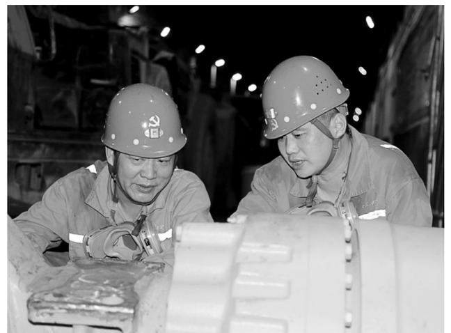
冬瓜山铜矿针对矿山大型设备多、使用率高、损耗大的情况,加大“TPM”设备管理工作力度,做到日常保养、维护、检修“三到位”,保障设备稳定运行。今年1至7月份,矿山节约备件费用近千万元。图为设备管理专业人员在井下负850米中段维修库检查电动铲运机前桥部件。
