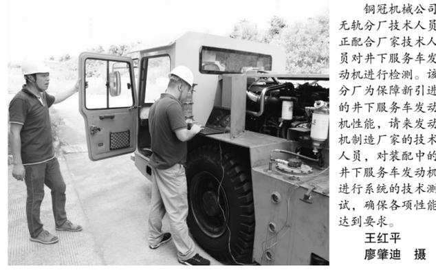
铜冠机械公司无轨分厂技术人员正配合厂家技术人员对井下服务车发动机进行检测。该分厂为保障新引进的井下服务车发动机的性能,请来发动机制造厂家的技术人员,对装配中的井下服务车发动机进行系统的技术测试,确保各项性能达到要求。王红平 廖肇迪 摄
