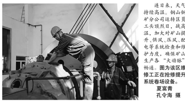
连日来,天气持续高温。铜山铜矿分公司运转区员工头顶烈日,战高温,加大对矿山提升、供风、压风、配电等系统检查和维护力度,确保矿山生产各“大动脉”畅通。图为该区维修工正在抢修提升系统卷扬设备。夏富青 孔令海 摄
