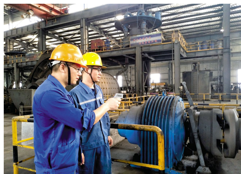
近日，铜山铜矿分公司选矿车间设备技术人员对车间各类大型设备进行“量体温”测温，及时把握设备运行状态，防高温天气下设备“中暑”。张霞 丁宜生 摄
