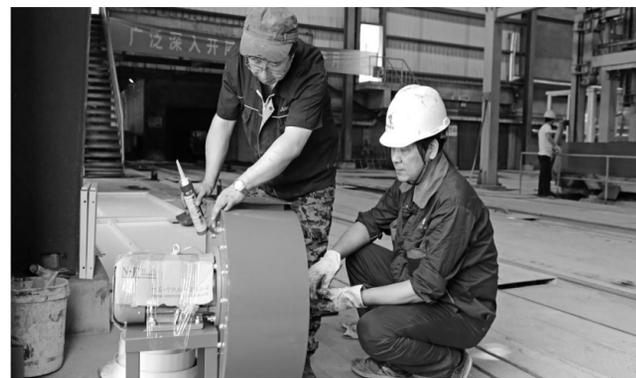
铜冠建材公司职工正在车间组装自动喷油新设备。铜冠建材公司在提高砌块生产自动化中,新采购了自动喷油机械手,用于砌块模具脱模喷油作业,用以替代过去人工喷油。这可以降低用工劳动强度,改善作业环境,又能提高作业效率和喷油效果。王红平 高明 摄
