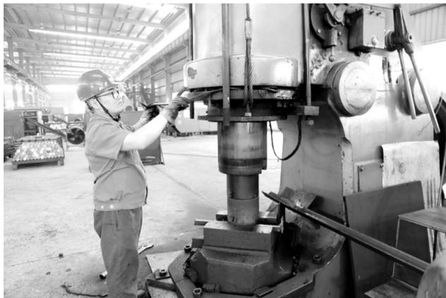
铜冠投资金耐磨材料公司职工日前正在更换空气锤胶圈。铜冠投资金耐磨材料公司为降本增效,结合订单生产需求,尽量将锻球生产安排在晚班,充分利用低谷电生产。同时,利用白班修整时间,积极做好生产设备的维护保养,保障了设备的可靠运行。 王红平 施家龙 摄
