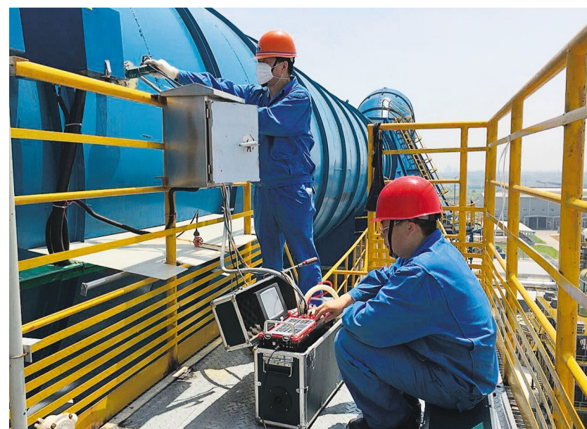
日前,环境监测站对奥炉项目部高20多米、40多米和60多米处的管道开展颗粒物、二氧化硫、氮氧化物等多项目的应急高空烟气监测(如图)。此次烟气监测历时5个多小时,是环境监测站首次在超过30米的高处(高度达特级高处作业级别)对温度高达50摄氏度的管道开展的烟气监测作业。 杨辉灼摄
