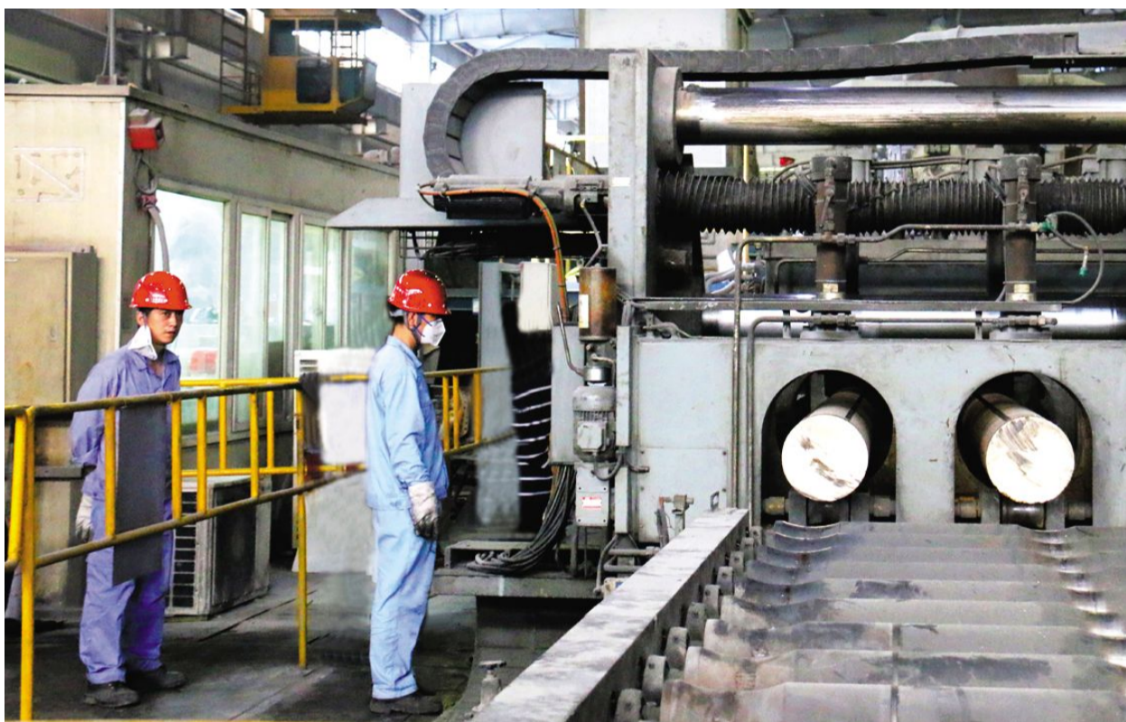
6月5日,铜冠黄铜公司熔铸系统“二流”生产试验成功进行。铜冠黄铜公司此次对熔铸系统进行技术改造,旨在进一步提升产能,满足日益增长的市场需求,改造成功将一举解决产量提升难题,将使熔铸日最高产量由84吨增长到144吨。
