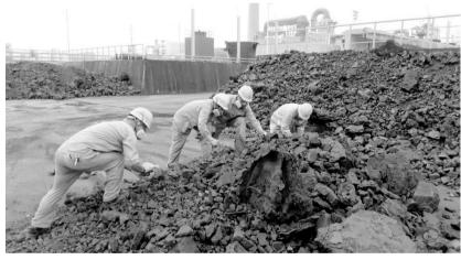
近日,金冠铜业分公司奥炉精炼车间吹炼炉工序组织员工利用休息日,对吹 炼炉渣堆场的含铜物料进行分检回收,归集的含铜物料约5吨。这些含铜物料将 作为冷料进入吹炼炉生产,在增加吹炼炉产量的同时,也减少了"三废"的排放。
