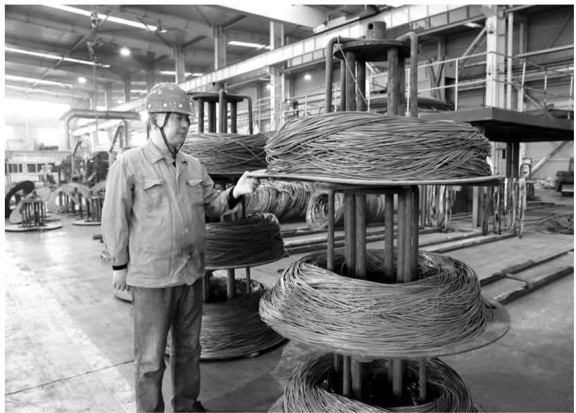
铜冠黄铜公司职工正在查看新退火料架。铜冠黄铜公司盘拉生产中过去退火料架盘卷钢线是单层盘绕堆放,影响了退火炉退火工作效率。为此该公司组织技术攻关,对盘拉中间退火料架进行改进,将新制料架改为三层叠放结构,这既避免了集中堆放于一层使底层盘卷料承受过大被压伤,又充分利用旧料架上半部分闲置空间,使退火炉中加热和冷却更均匀,提高了退火效率。王红平 汪勇摄
