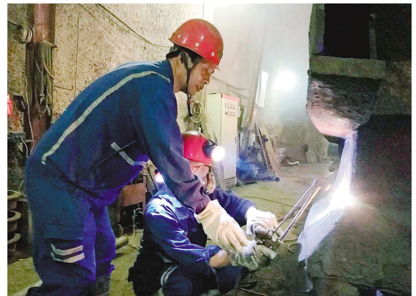
5月9日中班,铜山铜矿分公司负658中段电机车维修间的钳焊工刘大华正在指导钳工章正华气割车皮磨损部位。该公司开展导师带徒活动,积极倡导“一专多能、一人多用”的维修新模式,要求维修人员每人精通一门专业,同时兼会其他专业,不断提高维修技能。
