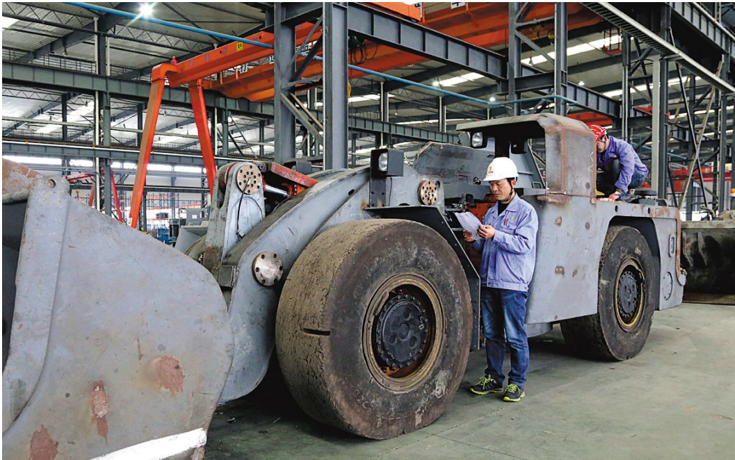
铜冠机械公司无轨分厂职工日前正在维修进口铲运机。铜冠机械公司针对冬瓜山铜矿进口3立方米铲运机故障，在维保中积极开展国产化改造，对一些原器件成功实现了国产部件替代，不仅降低了维修成本，也为客户提供了维修便利。
