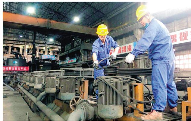
凤凰山矿业公司选矿车间在“五一”节当天,利用停产间隙及时对选矿中碎双层振动筛进行更换,以确保及时提矿。图为更换现场。段青 何娇 摄
