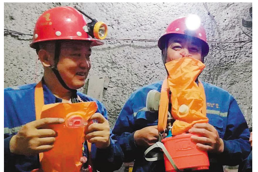
铜山铜矿分公司采矿业职工在负568米中段试戴个人防护自救器。为预防突发性灾害,日前,该公司为每名井下作业人员都配备了专用自救器,要求下井时随身携带,强化应急管理,切实提高矿山安全生产水平和员工现场自救能力。 余飞 摄
