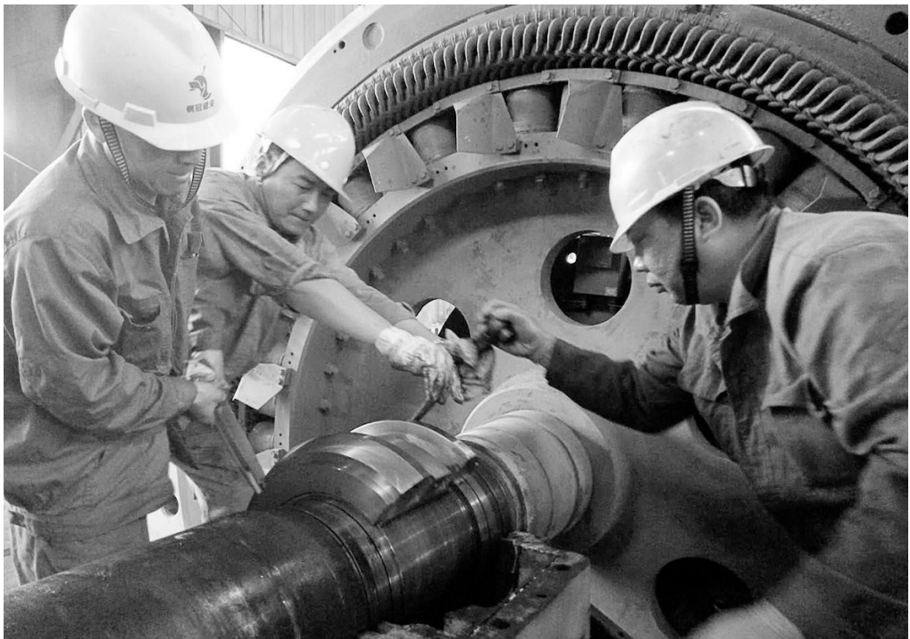
4月12日,铜山铜矿分公司选矿车间在铜冠建安公司维修人员的协助下,正在突击抢修半自动球磨电机轴瓦。为减少降低设备生产带来的影响,该公司采取走出去,引进来的互惠互补方式,加大对大型机电设备的妥善管理和维护,较好地缓解了公司生产人力与技术资源上存在的不足。
