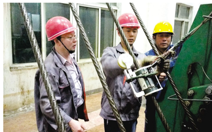
近日,铜山铜矿分公司对主井提升首绳进行“把脉问诊”。据了解,该公司强化提升运输设备设施的日常检查和检测检验工作,加大提升运输系统隐患排查治理力度,加强对提升运输系统尤其是钢丝绳、绳卡、罐道、安全卡等安全设施的日常维护保养和安全生产检查,以确保设备健康上岗。 刘少结 摄
