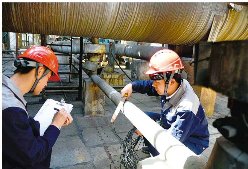
金隆铜业公司未雨绸缪,邀请专业防雷机构对所有机械设备进行防雷效果检测与评估,详细记录设备的接地数据,确保设备安全。 章庆 摄
