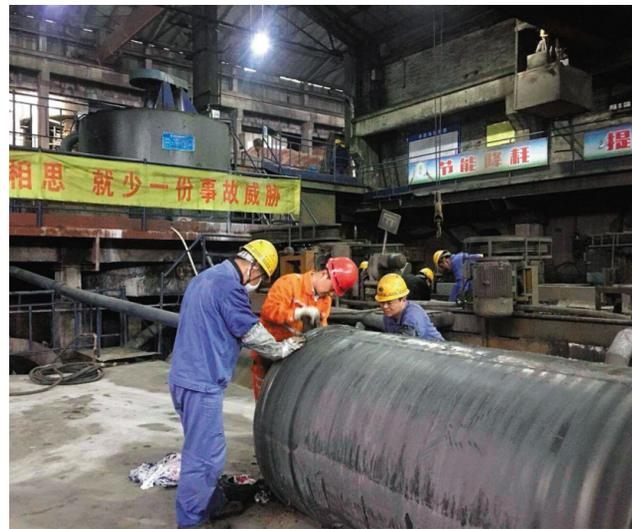
清明节加班期间，凤凰山矿业公司选矿车间利用停车时间，对车间部分设备进行检修。此次检修的主要项目有4-60破碎机解体检查、棒磨机传动齿轮轴承更换、棒磨机进料、筒体压条部分更换以及所有浮选机传动部位检查或更换、粗选磁选机槽体更换等。
