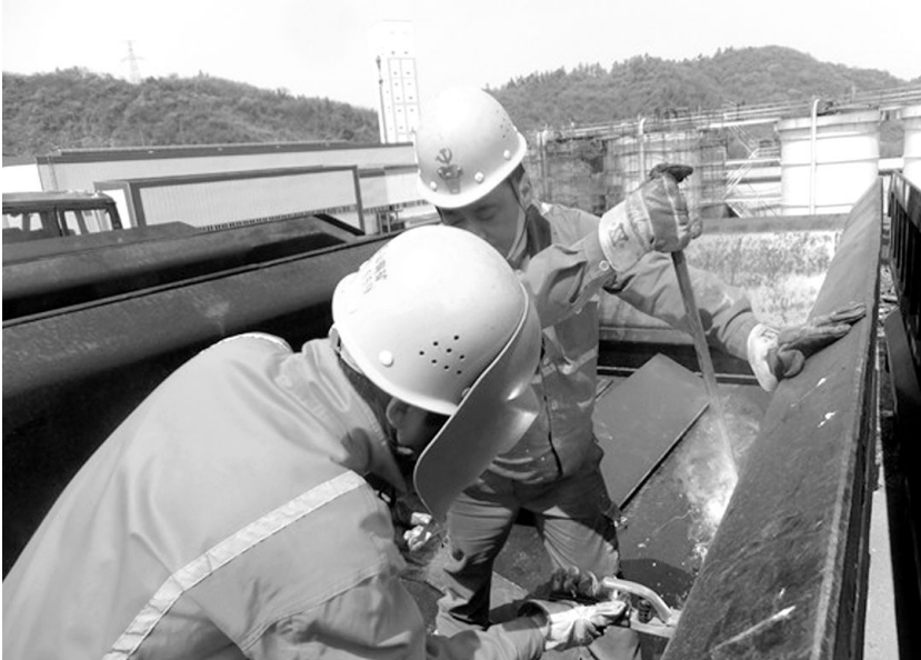
3月27日，冬瓜山铜矿运输区维修人员在正 107 米地表对即将打运到井下的 10 立方米矿车帮壁用衬板进行加固（如图），以降低放矿过程中对矿车的磨损，延长其使用期限。今年以来，该区紧盯年度各项考核指标，根据生产实际，在运输生产过程中，持续开展精细化管理，挖潜降耗，以“小”成本发挥“大”效益。 左勇 摄
