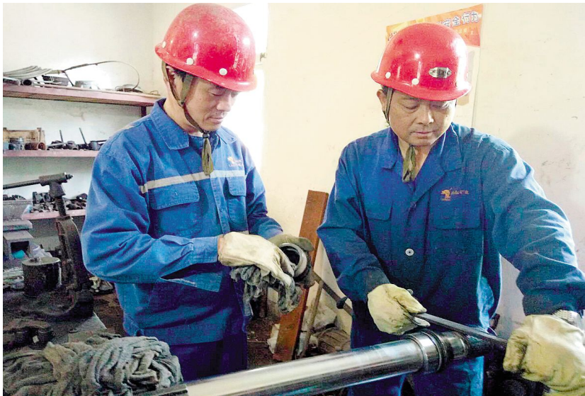
3月28日,铜山铜矿分公司工程区维修人员正在修复改进T-150钻孔机顶升降杆。该公司大力开展降本增效生产竞赛活动,立足基层岗位从点滴做起,多渠道地组织开展修旧利废活动,有效地缓解了备品配件材料供应的压力,助推全矿挖潜降耗工作朝着制度化、规范化和长效化方向迈进。 吴健摄
