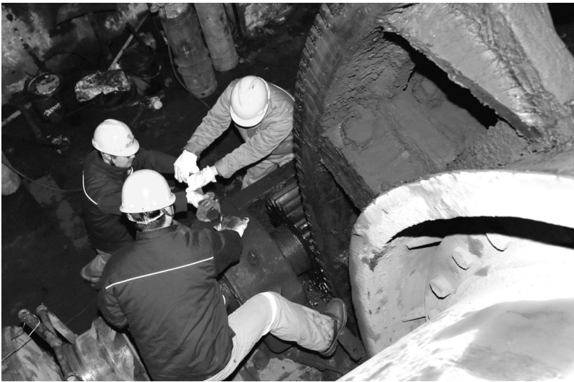
3月16日上午，安庆铜矿选矿车间1号球磨机改造进入收尾调试阶段，预计改造后将节约能源至少6%，至此，该矿所有球磨机全部实行了节能改造。据了解，该矿近年来每年都安排专项资金对耗电量的设备进行技改和淘汰，不但节约了能耗，也减少了设备故障率增强了安全性，并更加便于维修维护。 杨勤华 摄
