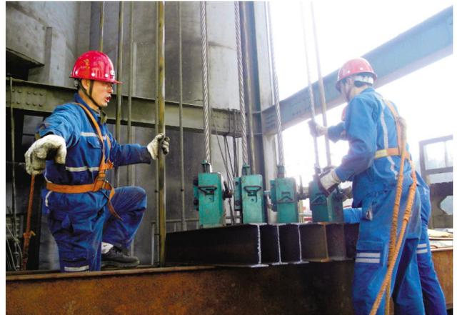
3月13日上午,铜山铜矿分公司运转区机修班员工在对主井提升钢丝绳自然伸长的部分进行收绳,确保提升系统安全。该公司加强对井筒、罐笼等安全检查和维修保养,严格执行管理技术标准,要求维修人员定期对提升系统的钢绳、滚绳、滚轮、钢梁、罐道木等重点部位进行检查,确保各部位运作正常。方成达 摄
