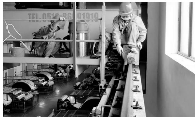
为保障特种设备的使用安全和使用寿命,安徽铜冠铜箔公司三、四工场对工场的特种设备开展了维护保养活动。针对特种设备所在环境,使用频率的特点对不同的设备制定了不同的保养清洁计划。 图为三工场磨辊班员工清洁、润滑车间内行车轨道。 陈潇 吴俊 吴博文 摄
