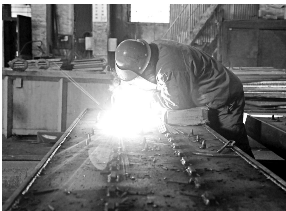
2月17日大年初二,铜冠机械公司矿冶设备制造分厂职工正在加班加点制作新疆项目水套。铜冠机械公司矿冶设备制造分厂继去年完成奥炉、厄瓜多尔、冬瓜山、铜冠铜箔等重要项目非标设备的加工制作后,为确保今年在手重点项目稳步推进,按期交货,春节长假期间,分厂组织全体职工从大年初二起就转入正常上班,加班加点开展加工制作,较好地保证了多个项目的加工进度。
