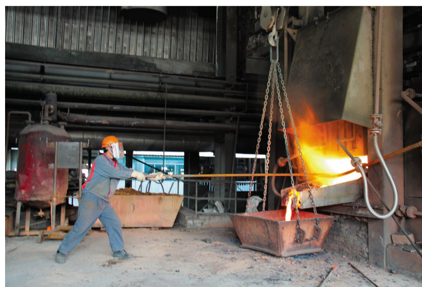
农历大年初一,张家港铜业公司精炼车间3号阳极炉生产出新春第一炉铜水,炉前工正在进行扒渣作业。春节期间,该公司广大干部职工主动放弃与家人团聚机会,坚守在工作岗位上。
