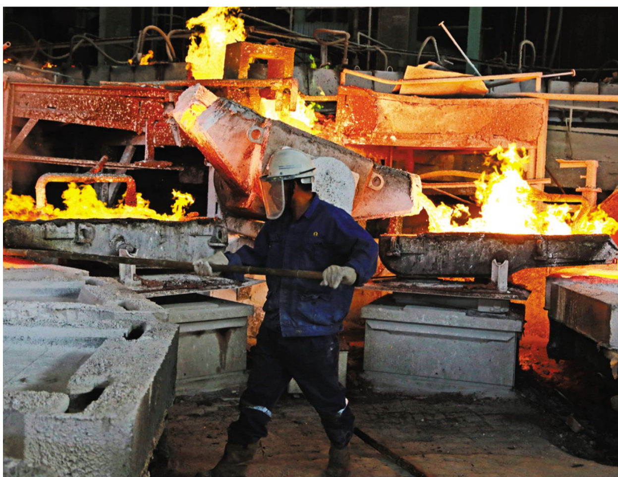
春节长假期间,金隆铜业公司职工正在进行阳极板浇筑作业。过去的一年,金隆、稀贵整合有序衔接,逐步并轨,生产经营取得超预期的可喜成绩。为保证整合后新年工作目标顺利完成,再创佳绩,春节长假期间,金隆铜业公司组织职工坚守岗位,开展正常生产作业,较好地保证了节日期间生产的平稳运行。
