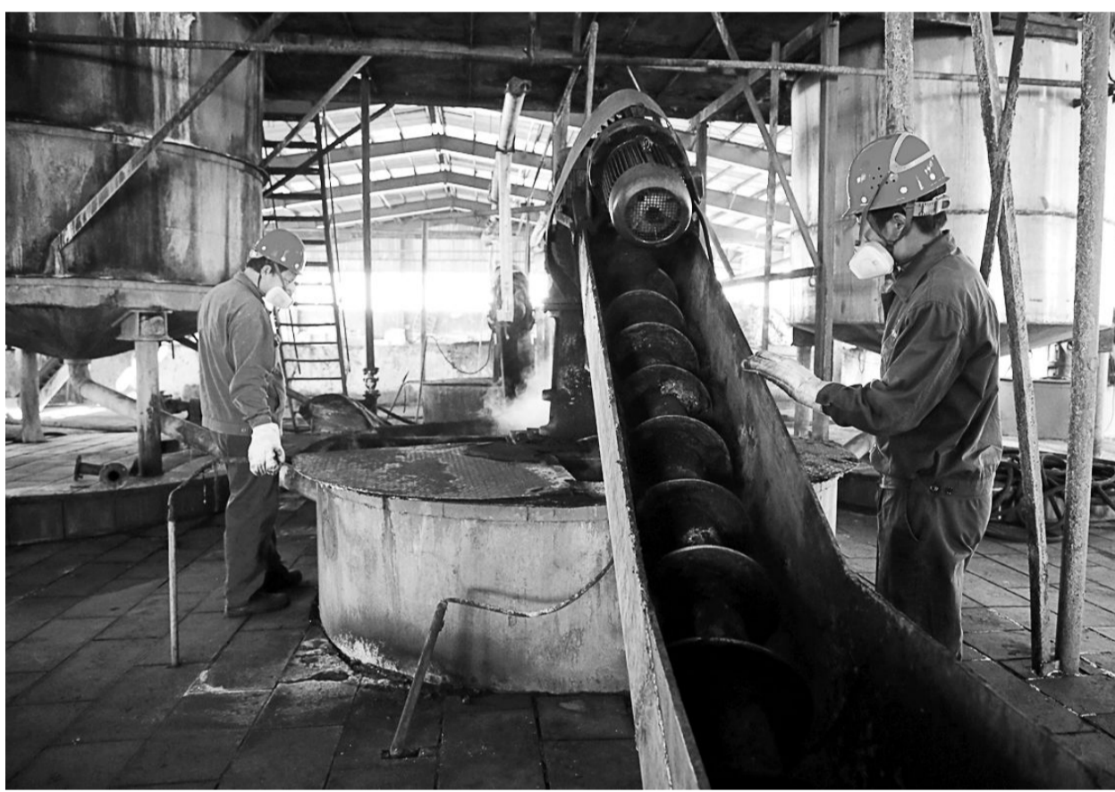
铜冠矿建公司职工日前正在硫化钠热化生产中作业。热化工段为硫化钠生产中的重要工序,热化溶出率直接影响到产品的产量。铜冠矿建公司针对热化过程中硫化钠溶出率只有92.62%这一偏低的现状,积极组织QC攻关,并通过对人员、工艺、原料和设备分析排查,确定了影响硫化钠溶出率的主要原因,有针对性地实施技术和操作上的改造改进,热化溶出率达到了96.00%以上。活动不仅产生直接经济效益,还提高了环保效果。
