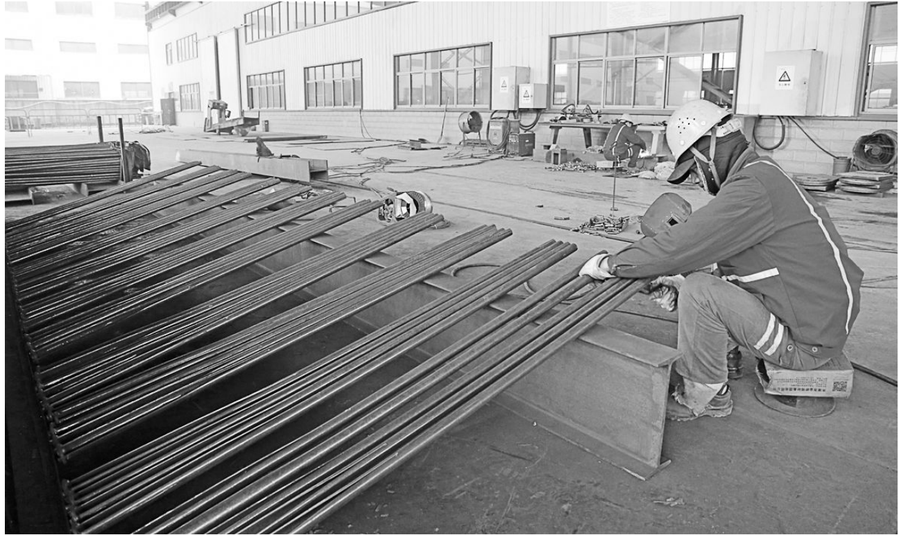
铜冠矿建公司机修厂职工日前正在制作锚杆。铜冠矿建公司机修厂积极发挥自身加工能力,2017年共生产制作锚杆10.6万根,不仅保证了自身矿建生产需要,还实现了部分外销,增加了创收渠道。
