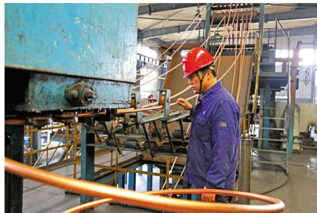
铜冠电业公司职工日前正在上引熔炉前生产磷铜合金棒坯作业。为推动产品不断向新能源领域拓展,铜冠电业公司今年积极与高校联合开展科研攻关,在电动汽车充电桩用易切削高磷铜合金研究取得了阶段性成果,在该公司磷铜分厂上引熔炉中成功生产出棒坯。目前该项目已获得了安徽省重大科技项目专项引导资金支持,并正在申报铜陵市相应的配套专项引导资金。王红平 芦广胜 摄
