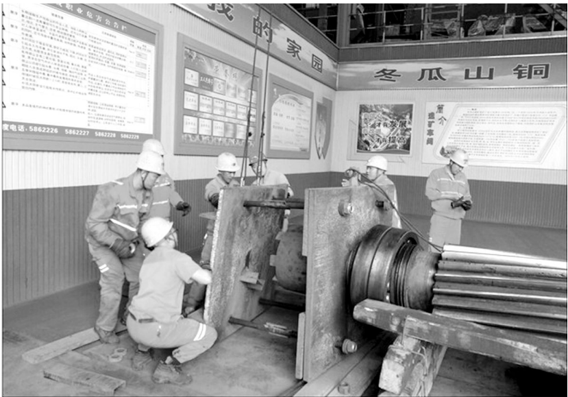
日前,冬瓜山铜矿选矿车间组织技术人员及各维修骨干对大修更换下的5米球磨机主动齿轮组进行清洗、打磨,并对驱动端和自由端联轴器进行调换,达到齿轮啮合面周边、旧备件再制造翻新的效果(如图),仅此一项为矿山节约备件费约120万元。
