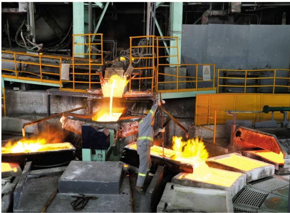
金冠铜业分公司圆盘工作人员在清理浇铸包内浮渣。圆盘连续浇铸作业过程中,浇铸包内浮渣量随着浇铸时间的延长而缓慢增加。虽有挡渣砖的存在,但是渣量过多的情况下,并不能完全保证浇铸的阳极板表面不出现浮渣。为此,圆盘员工定期清理浇铸包内浮渣,以保证阳极板质量。
