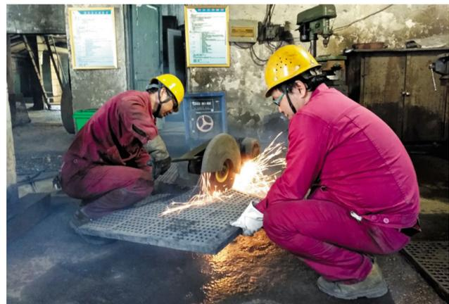
12月11日,天马山矿业公司选金车间碎矿大班对磨损严重的3号振动筛橡胶皮网进行更换。该车间坚持定期对设备进行“体检”,做到安全隐患早发现,早清除,确保安全生产。
