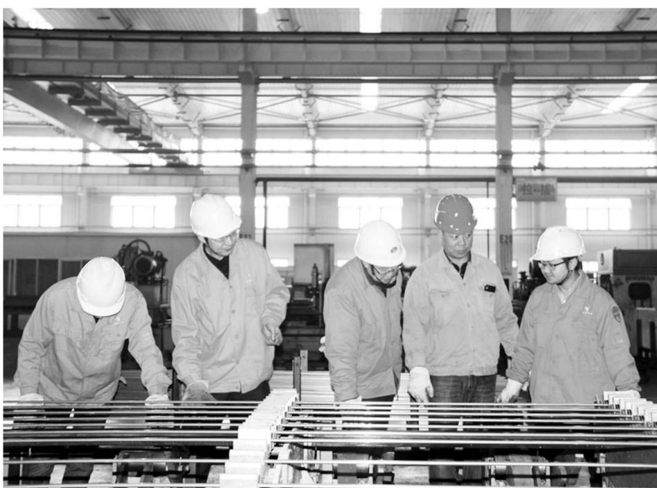
铜冠黄铜公司技术人员日前正在观察复熔焊接试验产品质量。为解决联合拉拔机产量瓶颈,提高生产效率,近期,铜冠黄铜公司组织技术及生产人员进行连续生产放线实验,主要通过改进上料方式,在线对焊实现连续生产。经过初步试验,可有效提高生产效率30%以上,后期仍有改善提升空间。
