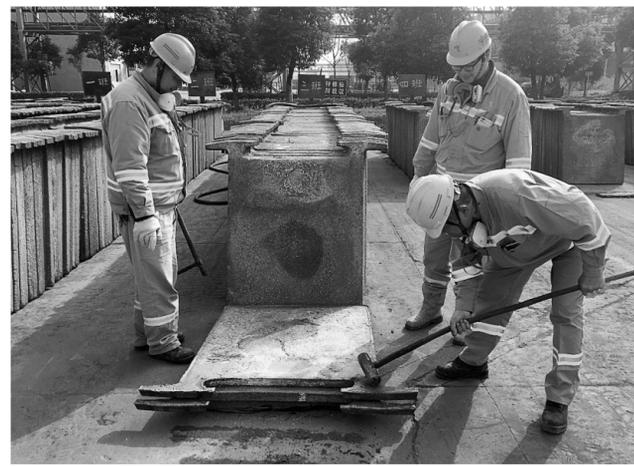
为保证阳极板质量,12月6日,金冠铜业分公司精炼车间班组成员每天对浇筑的阳极板上的结渣或毛刺进行修整。下半年以来,金冠铜业分公司在冲刺稳产高产的同时,仍将生产质量作为提升产品品质的要素来抓,实现了高产与质量并进势头。
