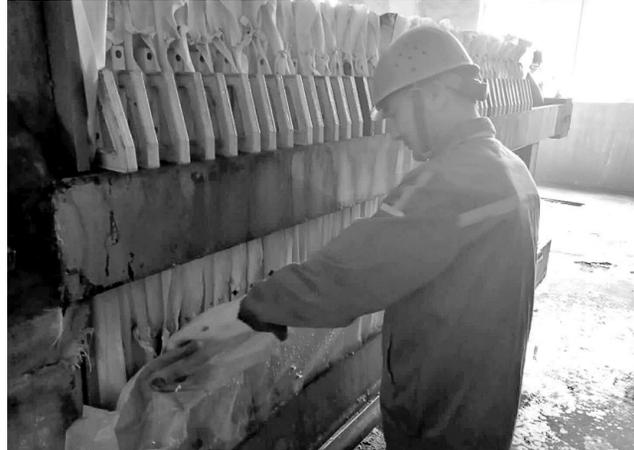
近年来,金铜矿业公司深入推行精细化管理模式,不断加强现场监管水平。针对压滤机在压滤过程中产生的电解液外溅现象,该公司电解车间在设备管理上主动想办法、出点子,通过采用在压滤机龙头上覆盖塑料布的方法,确保了压滤现场的干净整洁。图为该公司电解车间三期工段长赵文辉正在检查压滤机运行情况。
