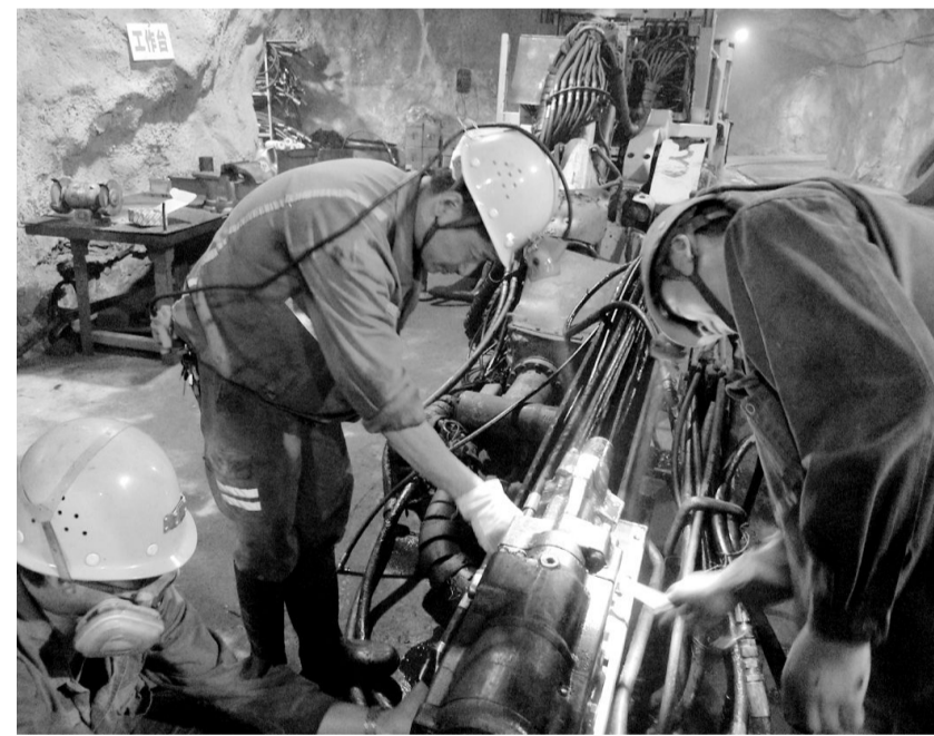
冬瓜山铜矿井下生产采、掘、出均采用大型高效的无轨设备,为实现设备备件国产化,努力降低生产成本,该矿在职工广泛开展技术攻关、小改小革、修旧利废等活动,确保全年实现节支4000万元。图为该矿维修工在井下维修281凿岩台车场景。 杨李军 摄
